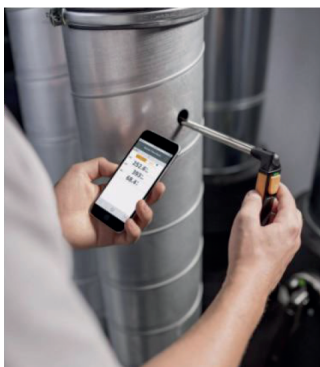
Figuur 48 De luchtsnelheid in de luchtafvoerbuïs meten
